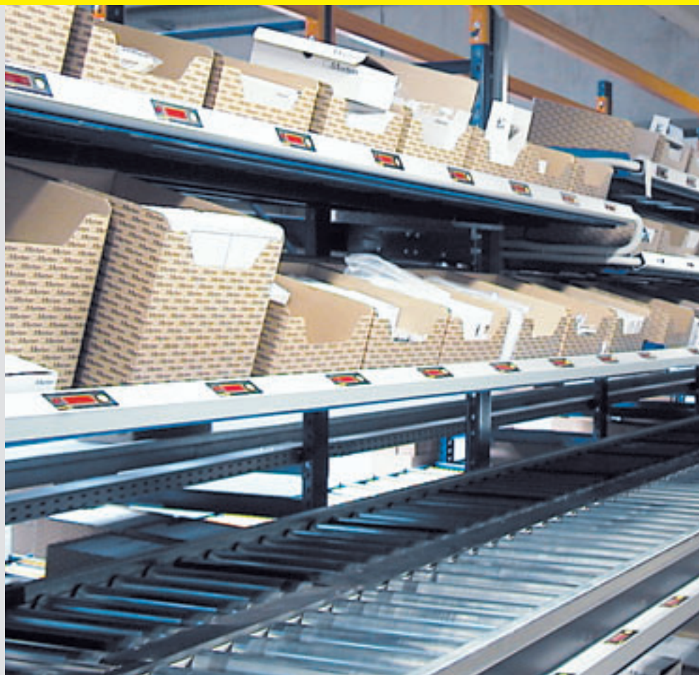
Figura de mai jos : Sistemul Pick-by-light diminuează marja de eroare și crește viteza de acces în sectorul electric
