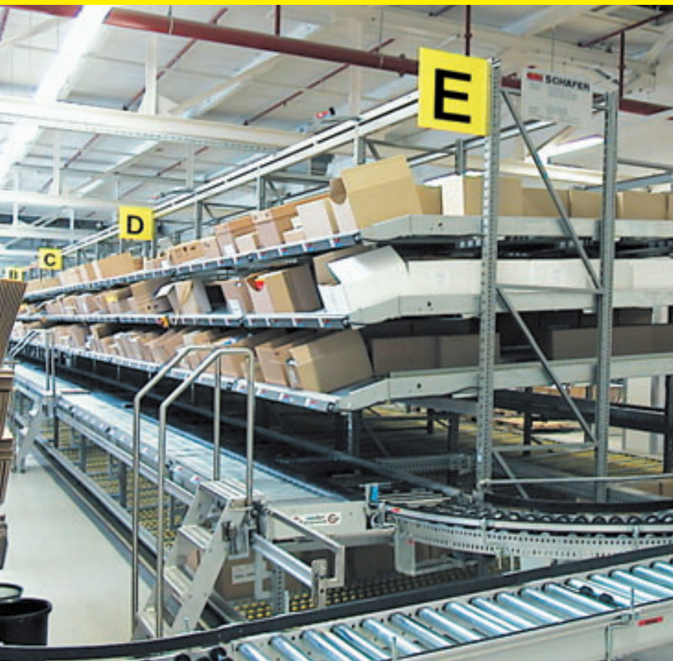
Figura de mai sus : Raft dinamic cutii cu conveioare integrate și sistem Pick-by-light în sectorul de editare Figura de mai jos : Raft dinamic pentru cutii cu tehnică de transport integrată și sistem Pick-by-light în sectorul farmaceutic
