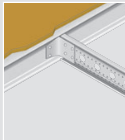
Suporturi de platforme care combină profile laminate la cald și profile de sistem
