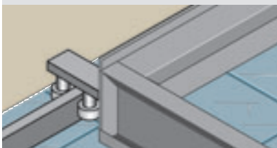
Executare fără șine
