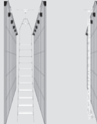
Scară mobilă FRD cu șine de ghidare și poziție de degajare a aleii
