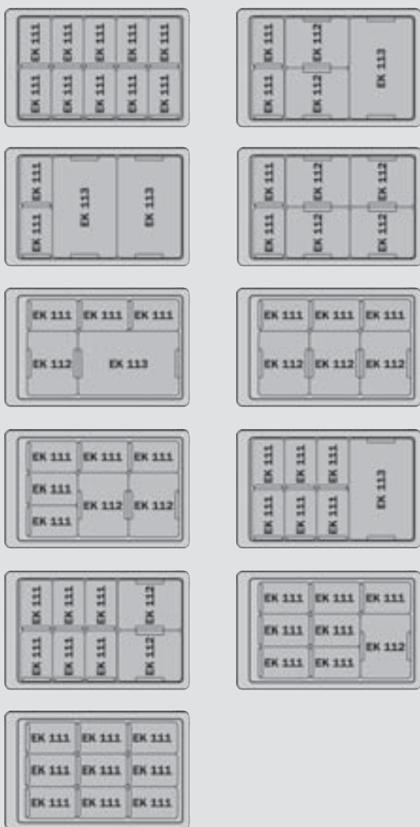
Exemple de compartimentare cu cutii intercalate pentru LF 531, LF 532 și LF 533
