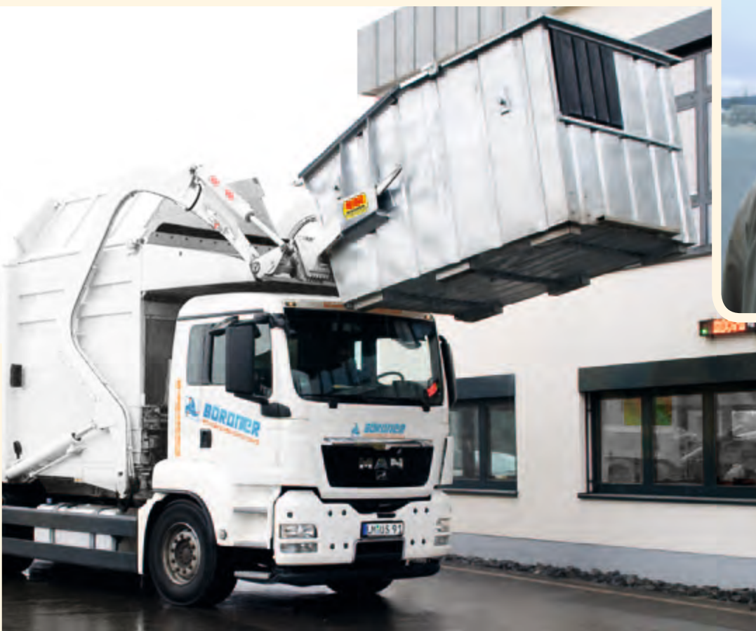
▼ Frontladerbehälter F 7,5 m 3 im Einsatz
